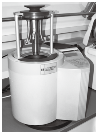
図 7b ハンドピース専用のオートクレーブ
